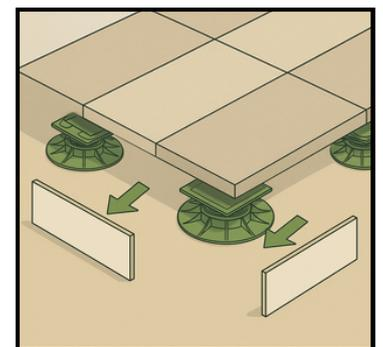
Fixer le support sur la base du plot et clipser la plaque à dalle.
