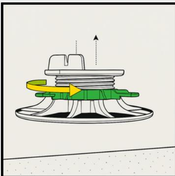
> Réglez la hauteur des plots en tournant l'écrou à la main jusqu'au niveau souhaité.
